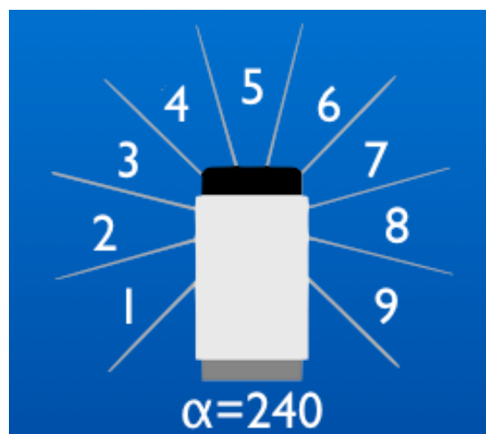
Figura 1. Esquema do retorno de dados gerado pelo sensor IR Seeker, utilizado para seguir a bola.
